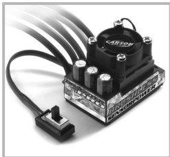
Regolatore per motori brushless PRO Sensor N. art. 906056
